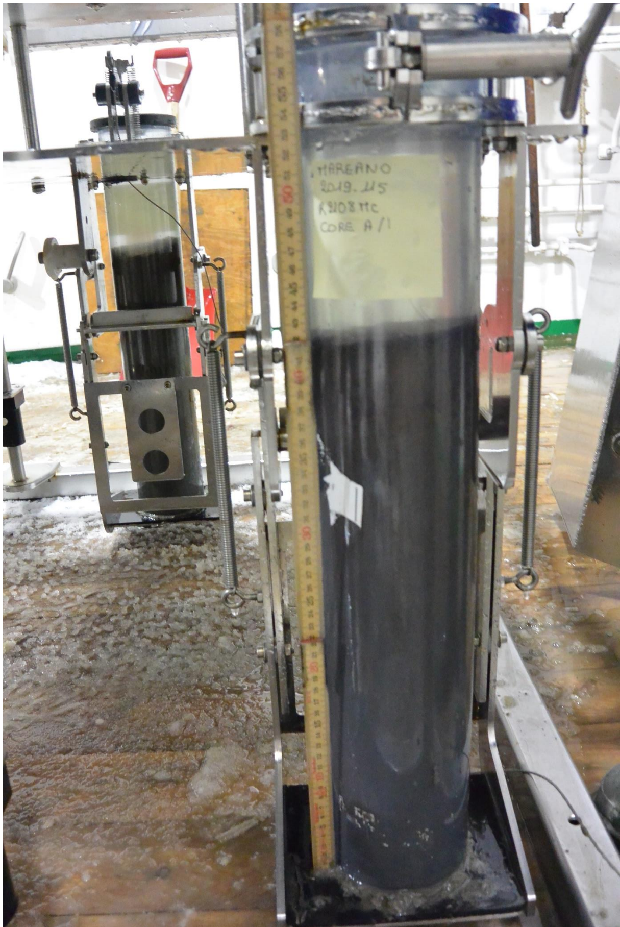
Figur 2. Stasjon R2108 multicorer sedimentkjerne for kjemianalyse (SK03) stående i multicoreren. Røret er 60 cm langt og sedimentkjernen har vannsøyle på toppen.
