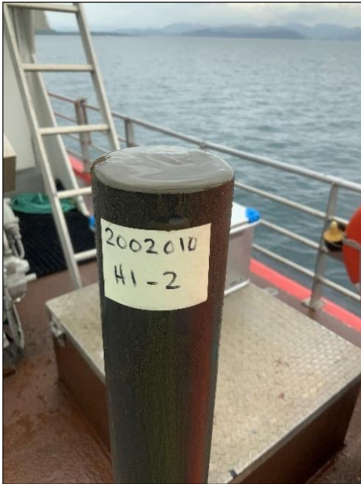
Figur 3. En kjerne fra multicoreren plasseres på en utdriver og skyves forsiktig ut av røret så overflaten kan prøvetas. Her brukes plastspatler siden materialet skal analyseres for innhold av metaller.
