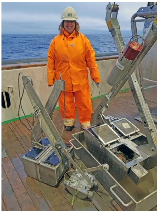
Figur 3: Valérie Bellec (NGU) ved de tre versjonene av van Veen-grabber, henholdsvis 0,15 m 2 (venstre), 0,025 m 2 (liten, midten) og 0,25 m 2 (stor, høyre), som blir brukt til biologisk og geologisk prøvetaking av havbunn. Mareano-tokt 2018109. Foto: Lilja R. Bjarnadóttir, NGU.
