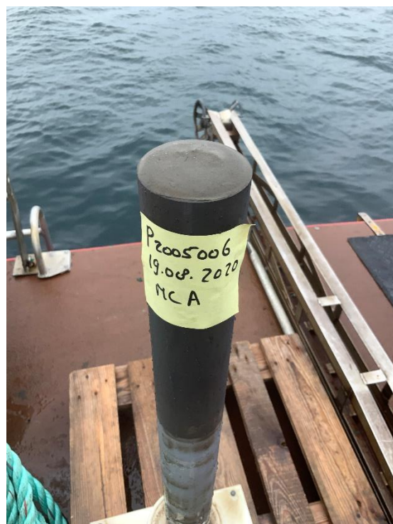
Figur 3. En kjerne fra multicoreren plasseres på en utdriver og skyves forsiktig ut av røret så overflaten kan prøvetas.
