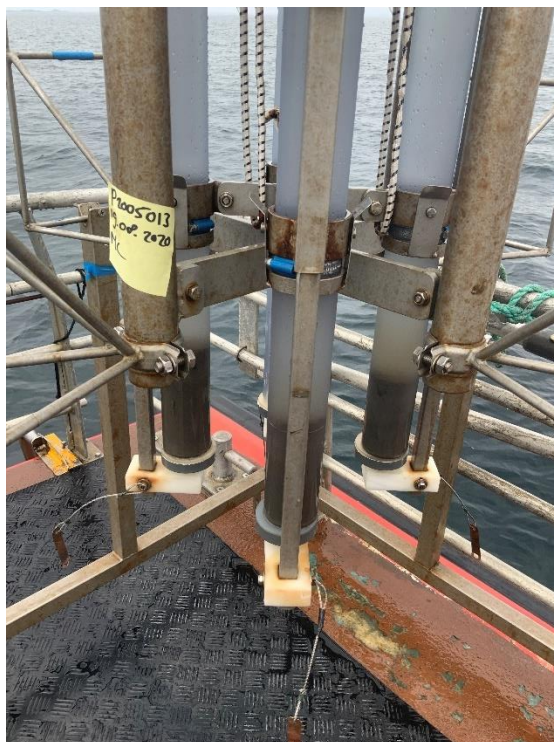
Figur 2. Prøvetaking med multicorer, som tar opptil fire kjerner per stasjon. Lukkemekanismen utløses idet prøvetakeren treffer bunnen, og stenger topp og bunn av hvert rør. For hver stasjon er de øverste 2 cm av én kjerne brukt til analyser av sedimentenes kornfordeling og metallsammensetning, og de øverste 2 cm fra to kjerne brukt til analyse av organiske miljøgifter.
