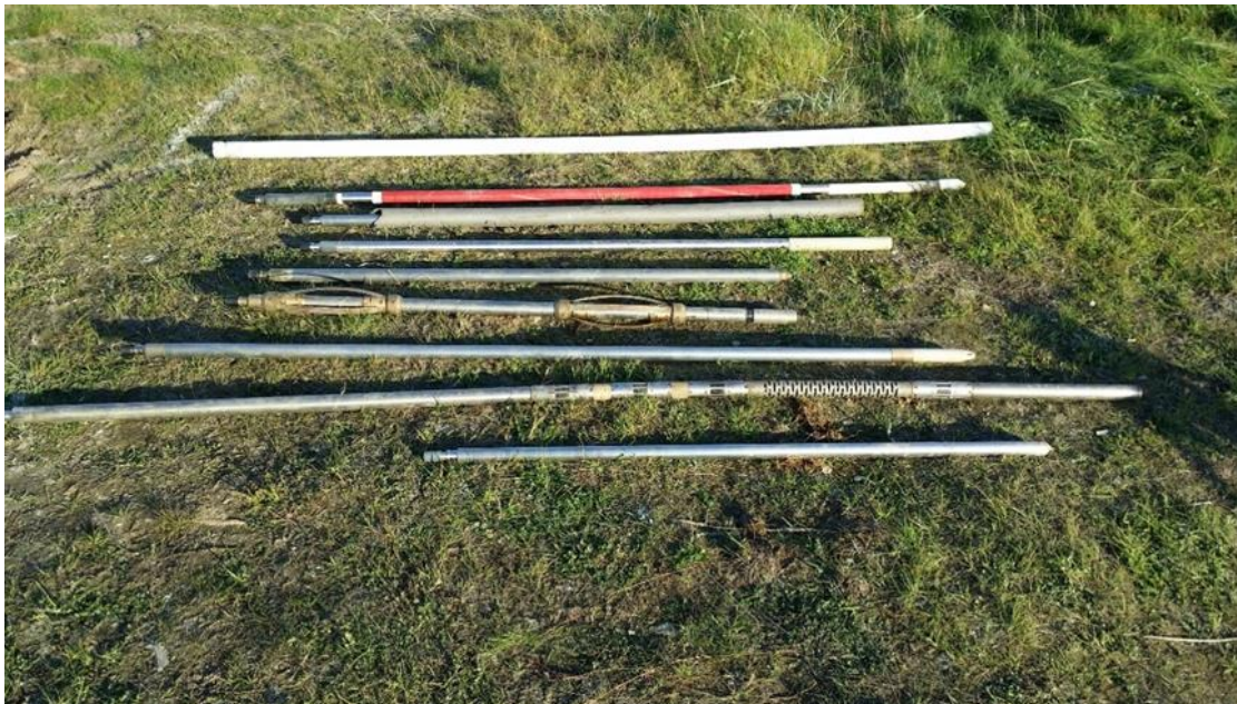
Figur 2. Noen av borehullssondene som NGU benytter.
