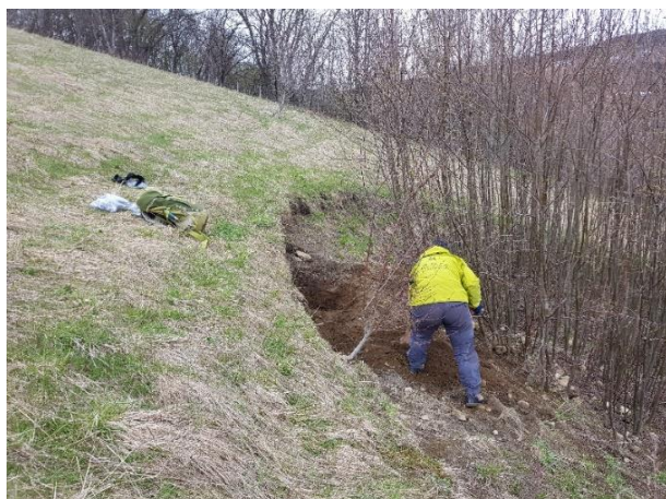
Figur 30. Graving av snitt i skredkanten ved Sørstuu_Estenstad (se Fig. 29 for plassering av snittet).
