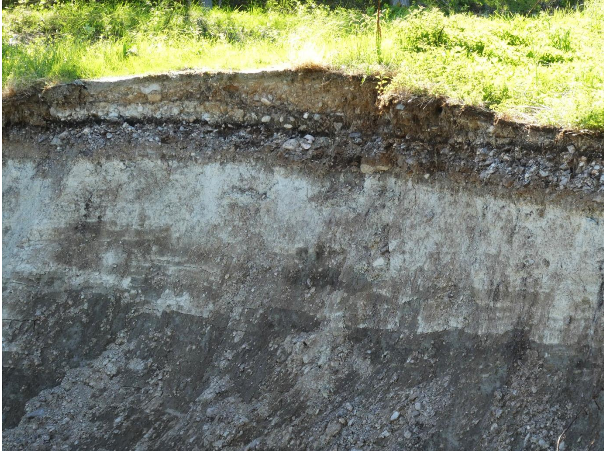
Figur 34. Lyse lag av uttørket, lagdelt leire/silt/sand under strandgrus i sektor VII. Det ser ut som det ligger et gruslag ved foten av det lyse laget. I toppen er det fyllmasser og to hjulspor er kuttet i den øverste venstre del av fotoet. Foto: Louise Hansen, 22. juni.
