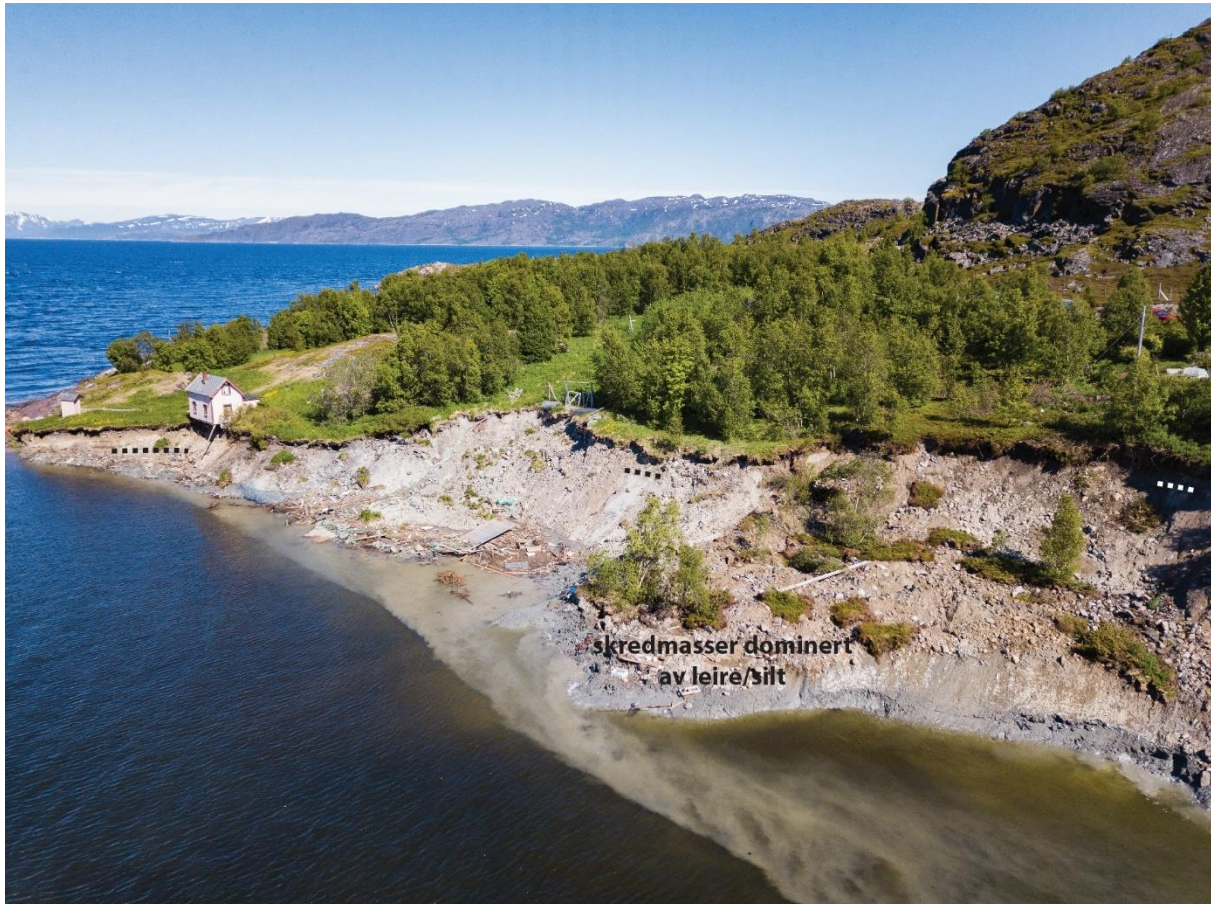
Figur 11. Foto fra drone i nordøstlig retning over skredkant i sektor I (foto: Raymond Eilertsen, 22. juni). Omtrentlig grense mellom leire/silt (grålig) under sand/grus/stein er stiplest. Leire/silt sees også ved foten av skredmassene i forgrunnen. Skråningen er dekket til slik at grensen mellom leire/silt og grus/stein kun kan anes enkelte steder et par meter under terreng (og fra tidligere bilder av skredet, Fig. 13).
