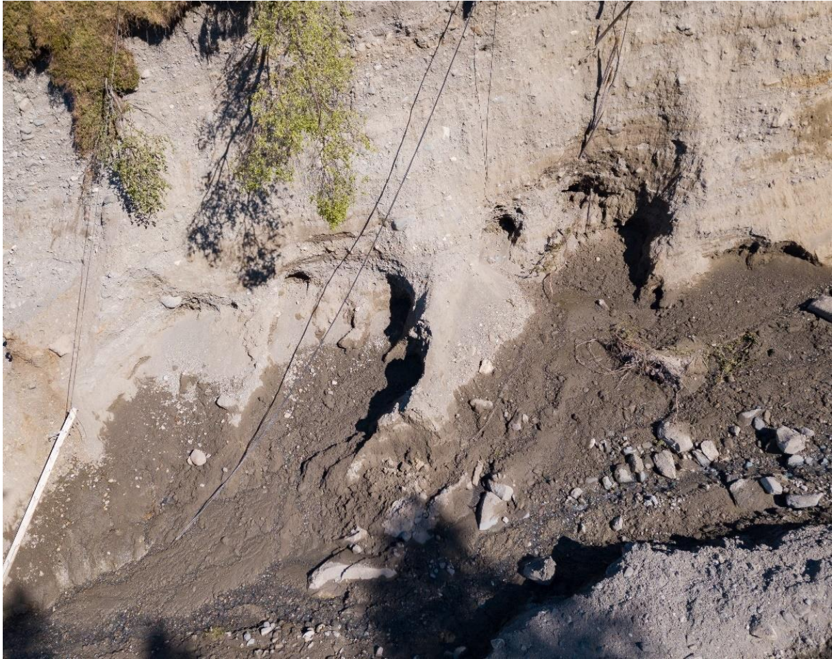
Figur 26. Nærfoto av groper ('pipes') ved foten av den lange profilveggen i sektor V mellom svarte piler vist i Fig. 21. De mørke sedimentene i nedre halvdel av fotoet er fuktig. Små sediment vifter synes å stamme fra et par av gropene, hvilket tyder på at det siver/har sivet vann og sediment (sedimentstrømmer) ut av disse. Foto: Raymond Eilertsen, 22. juni.
