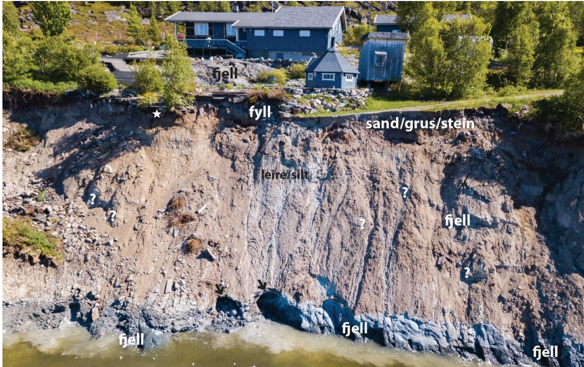
Figur 14. Fjell er blottet flere steder i sektor II. Mulig fjell er markert med spørsmålsteget. Ekspontert leire/silt er også vist. Over leire er det sand/grus/stein og fyllmasser. Svarte piler markerer hull hvorfra det ser ut til å vaskes ut leire/silt. Dette sees av den liten sky i vannet av leire ved høyre hull. Ved venstre hull er det vasket frem steiner. Foto: Raymond Eilertsen, 22. juni.
