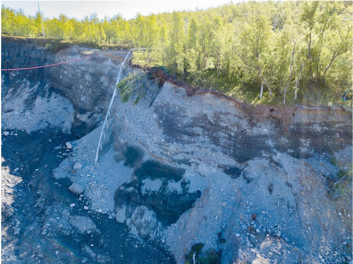
Figur 29. Tykke gruslag i den sørligste delen av skredkanten i sektor V. Den gjennombrutte Kråknesveien sees øverst til venstre. Den mørkere grusen ved basis skyldes fuktighet og/eller finstoff. Foto: Raymond Eilertsen, 22. juni.
