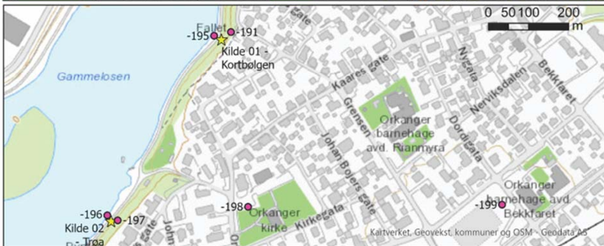
Figur 7: Lokalisering av kilder, sonderboringer og georadarprofiler på grunnvannsforekomst Orkanger. Nummerering av boringene er gitt ut fra de tre siste siffer i boringenes registreringsnumre i den nasjonale brønn databasen GRANADA.
