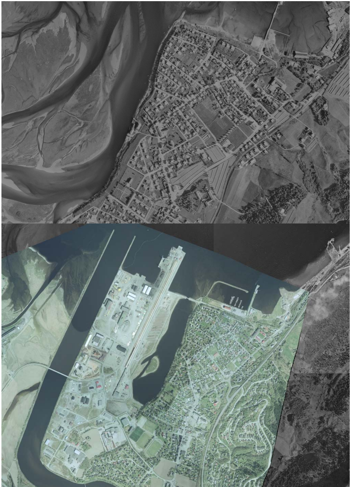
Figur 5: Flybilder av elveøra i Orkanger. Øverste flybilde er fra 1964 og det under fra 2002 med omlegging av elveløpet (kilde: historiske kart Finn.no).
