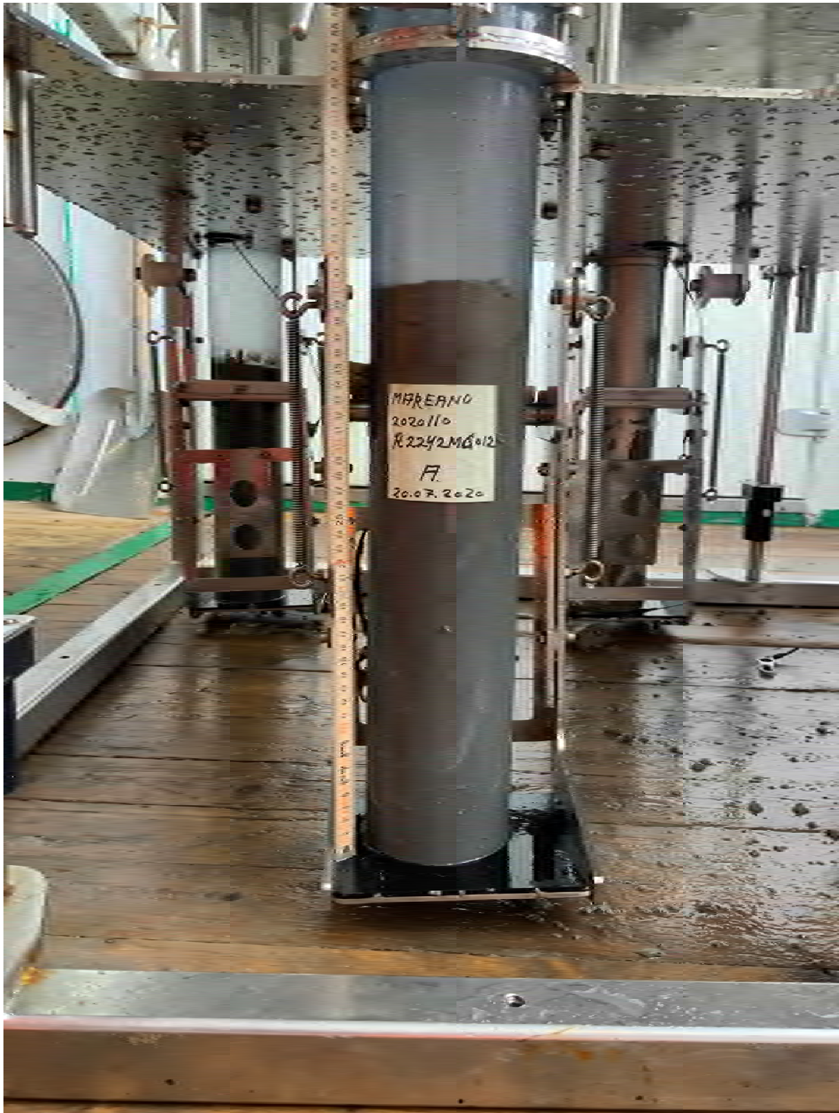
Figur 2. Sedimentkjerne fra Stasjon R2242 for kjemianalyse (Trænadjupet) stående i multicoreren. Røret er 60 cm langt og sedimentkjernen har vannsøyle på toppen og er dermed godkjent.
