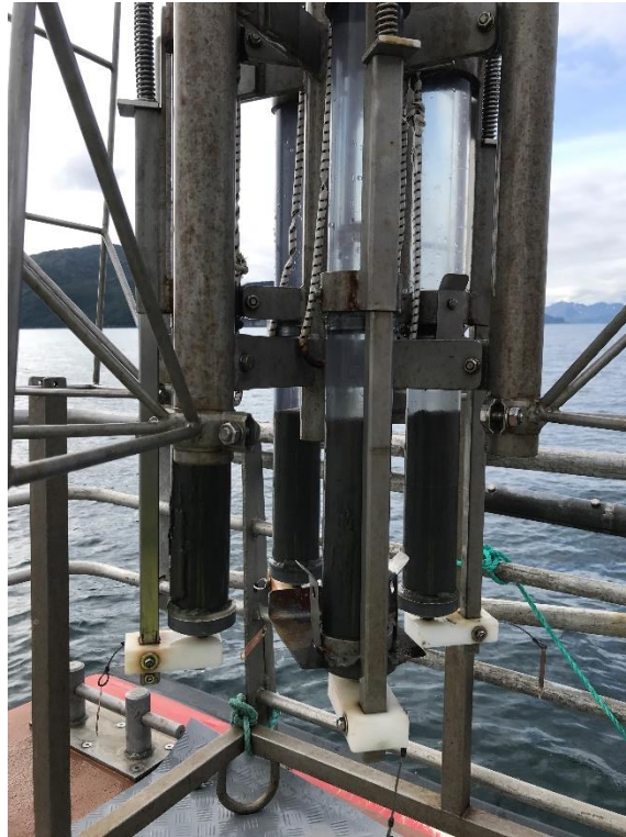
Figur 2. Prøvetaking med multicorer, som tar opptil fire kjerner per stasjon. Lukkemekanismen utløses idet prøvetakeren treffer bunnen, og stenger topp og bunn av hvert rør. For hver stasjon er de øverste 2 cm av én kjerne brukt til analyser av sedimentenes kornfordeling og metalsammensetning, og de øverste 2 cm fra to kjerner brukt til analyse av organiske miljøgifter.
