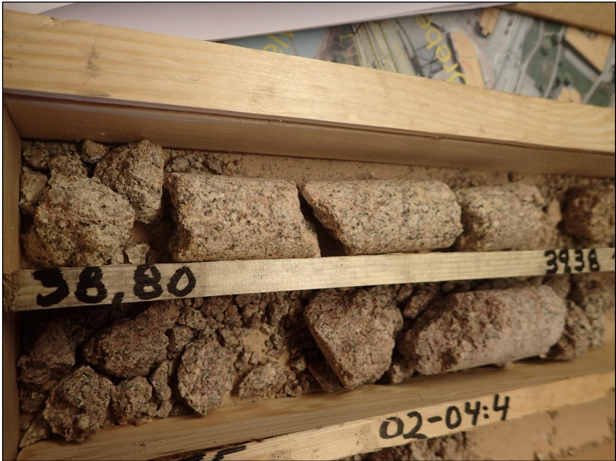
Figur 12. Foto av borekjerner fra Seut (Vegvesenets egne kjerner). Dette er tydelig forvitret granitt, hvor de tykkere leirsonene uteblir pga. kjernetap (foto: Guri Venvik, NGU).
