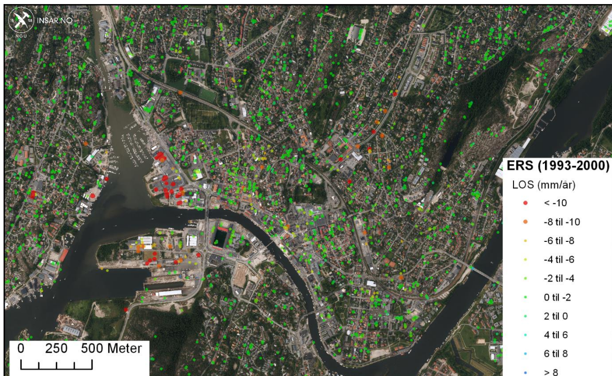
Figur 17. Setningshastighet basert på data fra ERS-satellitten for perioden 1993 til 2000. Setningshastigheten vises i mm/år langs «line-of-sight» (LOS), som er satellittens synsretning.
