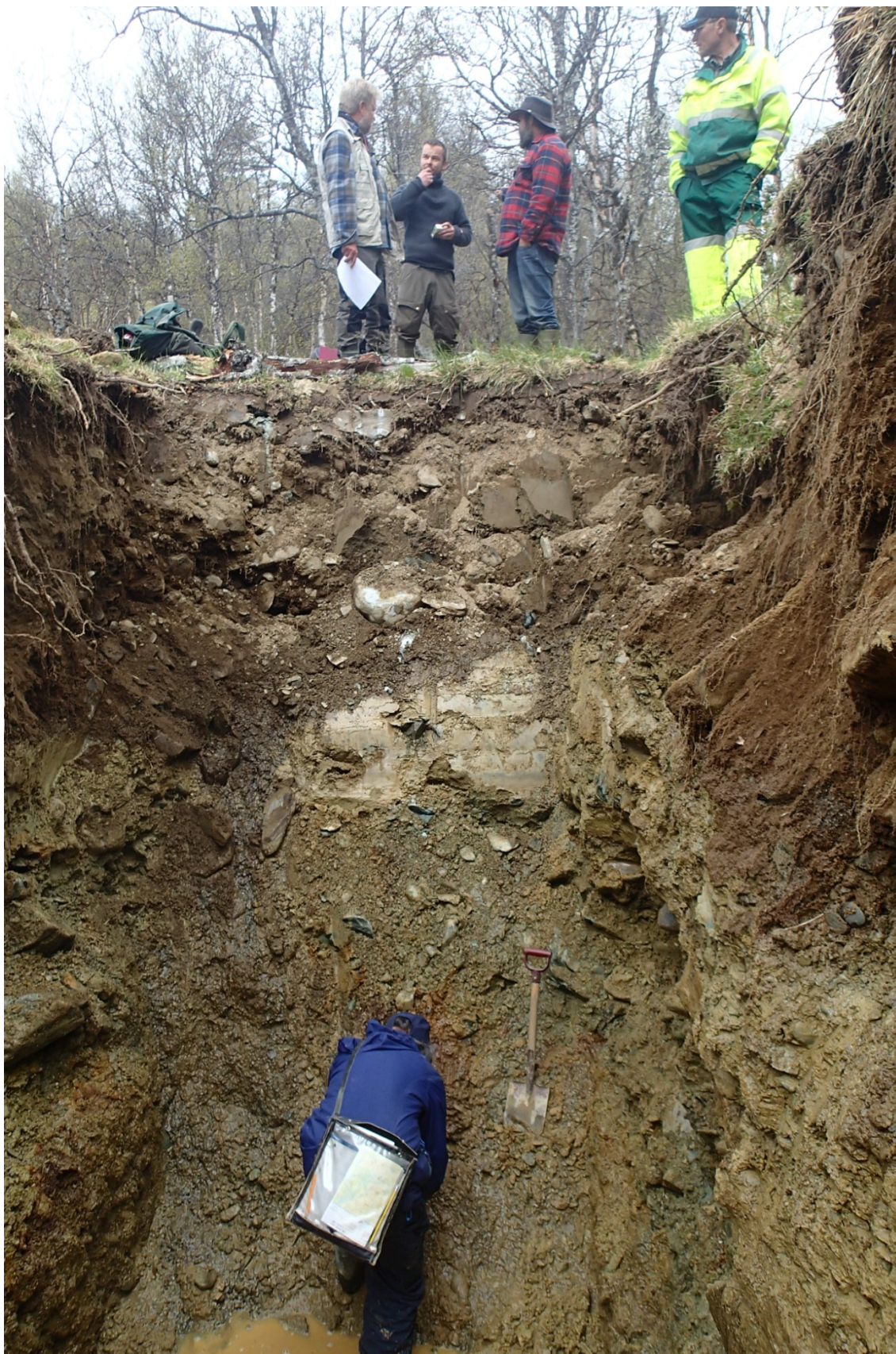
Figur 22. Grop G1-16/6-15. Gropa er på elvesletta/elvesenga midt i dalen (figur 17). Gjengitt som dypeste del av lagfølgen i Figur 27. Massene er dominerende grusrikt morenemateriale, med horisonter og linser av sand og silt, og med brelv- og elvegrus aller øverst i elvesenga.
