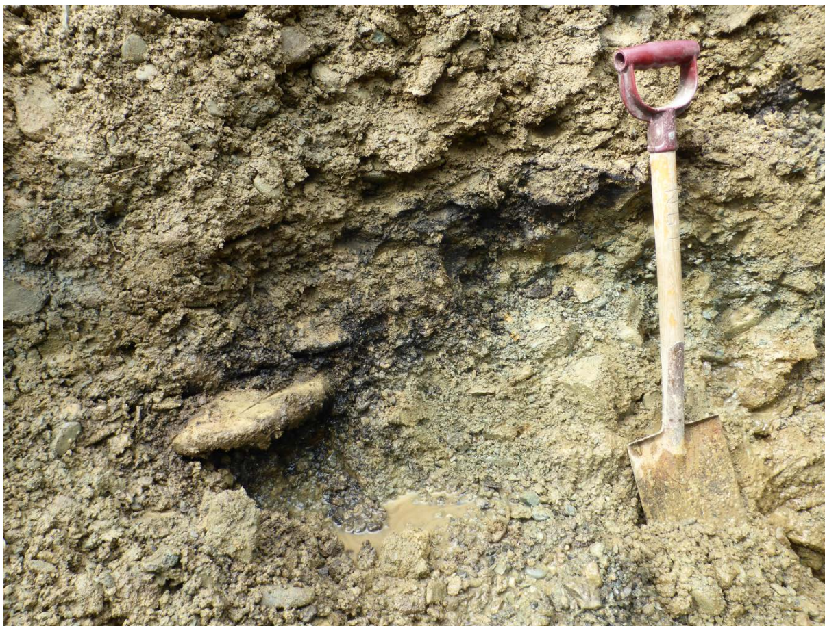
Figur 30. Tungminerallag som inneholder 30 ppb gull i grop G2-16/6-15. Dette er den høyeste gullverdien i prøver av løsmassene.
