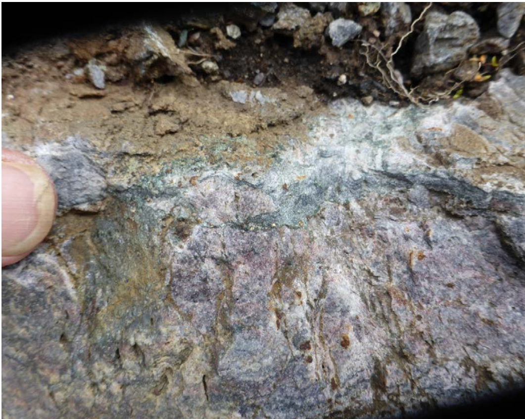
Figur 8. Magnetitt- og svovelkisførende chert langs seterveien over Falkhøa (Prøve JS15.07, UTM sone 32, 542325, 6957465 og JS15.08 UTM sone 32, 542327, 6957473).
