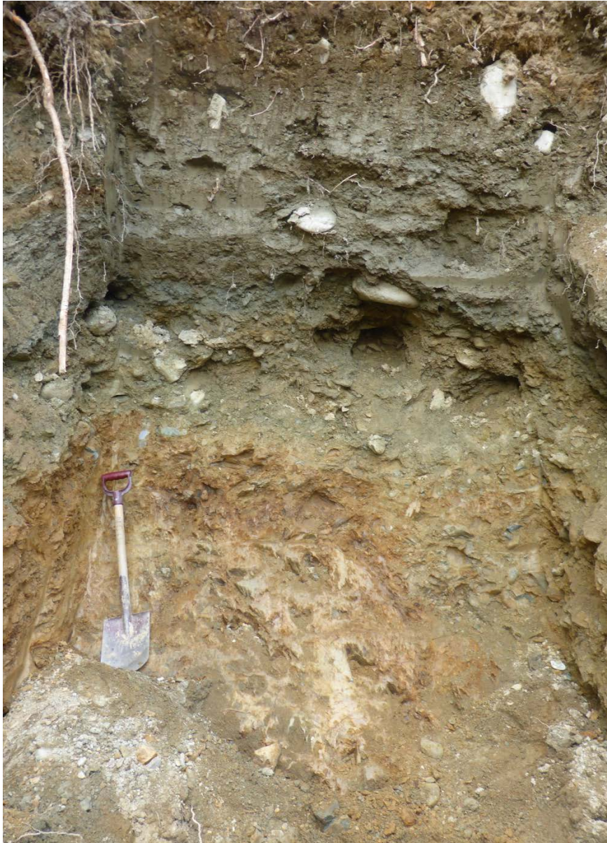
Figur 20. Grop G1-15/6-15. Forvitret fjell nederst, delvis finkornet materiale, beige til rustbrun sone. Over dette ligger grålig grus, morenemateriale og sand grus i usortert blanding med skråningsmateriale.
