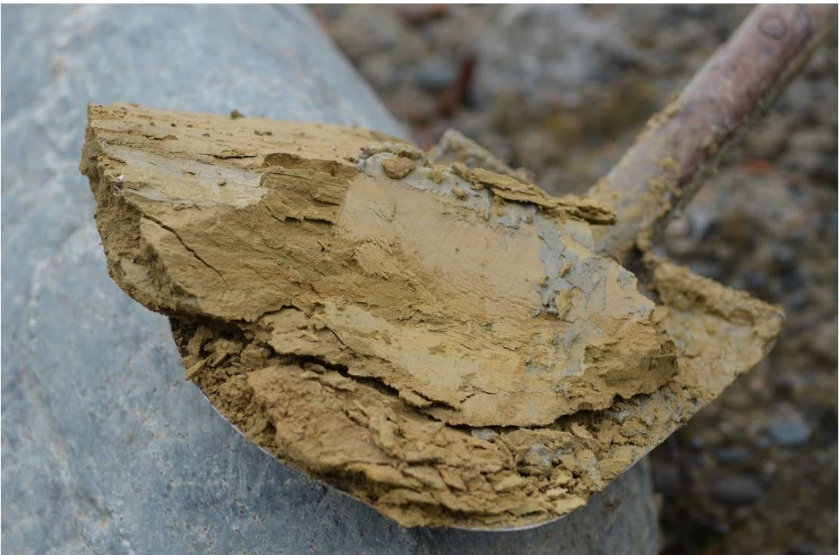
Figur 29. Klump av leirig/siltig bresjøsediment fra samme sted som vist på Figur 28.
