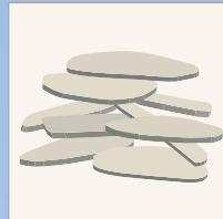
Omrørt leire etter ras Tettere og mer stabil kornstruktur.
