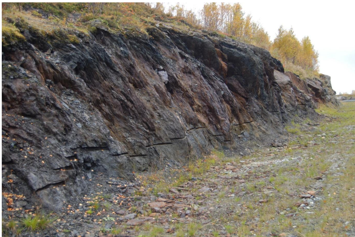
Figur 8: Typisk grafittisk fyllitt med anrikning av pyritt og pyrrhotitt i enkelte soner som gir rustdannelse. Lokalitet: Rv.73 i Krutådalen.
