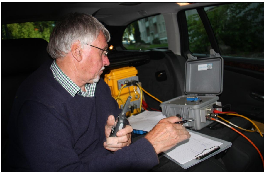
Figur 2: Gunther Druivenga styrer datainnsamlingen. Gule bokser bak er 3 X Geometrics Geode seismograf. Grå boks er signalgenerator utviklet ved LIAG.
