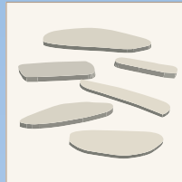
Kvikkleire under ras Kollaps av kornstruktur og overskudd av vann gir en tyntflytende leirsuppe.
