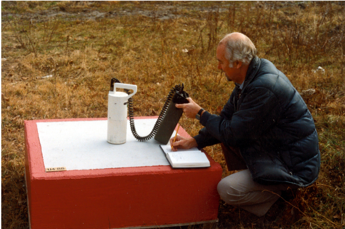
Figur 2: Kalibrering av instrument for måling av gammastråling på bakken. Ved å måle på 4 syntetiske prøver ("pads") med kjent innhold av uran, thorium og kalium, kan instrumentene kalibreres slik at konsentrasjoner av de radioaktive elementene på bakken kan beregnes.
