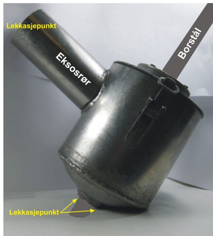
Figur 5. Prøvebeholderens stilling når boret står i vinkel til fjelloverflaten. Det er da gode muligheter for lekkasje av borkaks gjennom åpningen som dannes ved overgangen mellom fjell og prøvebeholder. Noe finkornet støv følger også returluften ut gjennom eksosrøret.
