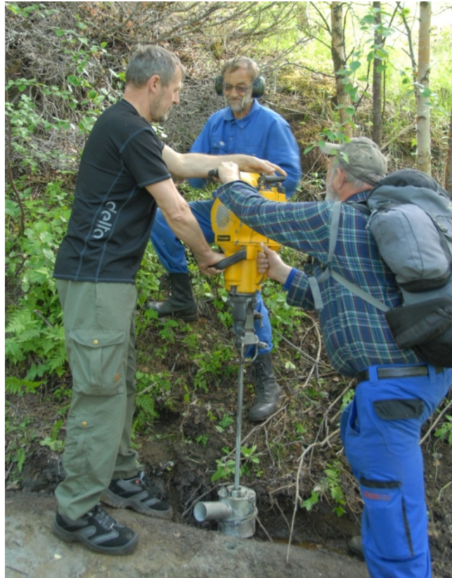
Figur 2. Pionjär slagbormaskin med prøvebeholder som hviler på bart fjell. Fra venstre grunneier Yngve Fløttkjær, overingeniør Leif Furuhaug og forsker Peter M. Ihlen som prøver å få start på en kald maskin.
