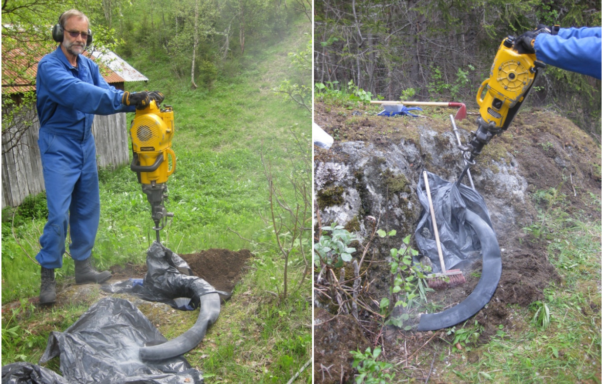
Figur 7. Til venstre boring av loddhull på horisontal overflate, dvs. L/H type hull, og til høyre boring av skråhull vertikalt på skrånende overflate (S/S type hull). Begge bilder viser hvordan prøvebeholderen er pakket inn i plastduk, samt den 1 m lange gummislangen som er montert på åpningen av eksosrøret. Legg merke til den tynne hinnen av grått finstøv på venstre bilde som er avsatt på plastduken utenfor munningen av gummislangen.
