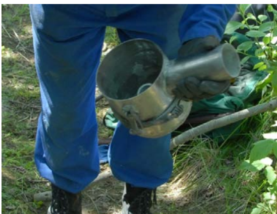
Figur 3. Bilder av prøvekammeret. Det venstre viser det innvendige av prøvekammeret med toppen av det innvendige røret synlig. Det høyre viser hvordan borkakset overføres fra kammeret til prøvepose med lynlås når topplokket er fjernet. Klemmelåsene som holder lokket på plass er også vist. Se også Figurene 4 og 5.
