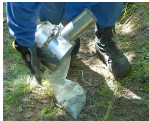
Figur 3. Bilder av prøvekammeret. Det venstre viser det innvendige av prøvekammeret med toppen av det innvendige røret synlig. Det høyre viser hvordan borkakset overføres fra kammeret til prøvepose med lynlås når topplokket er fjernet. Klemmelåsene som holder lokket på plass er også vist. Se også Figurene 4 og 5.
