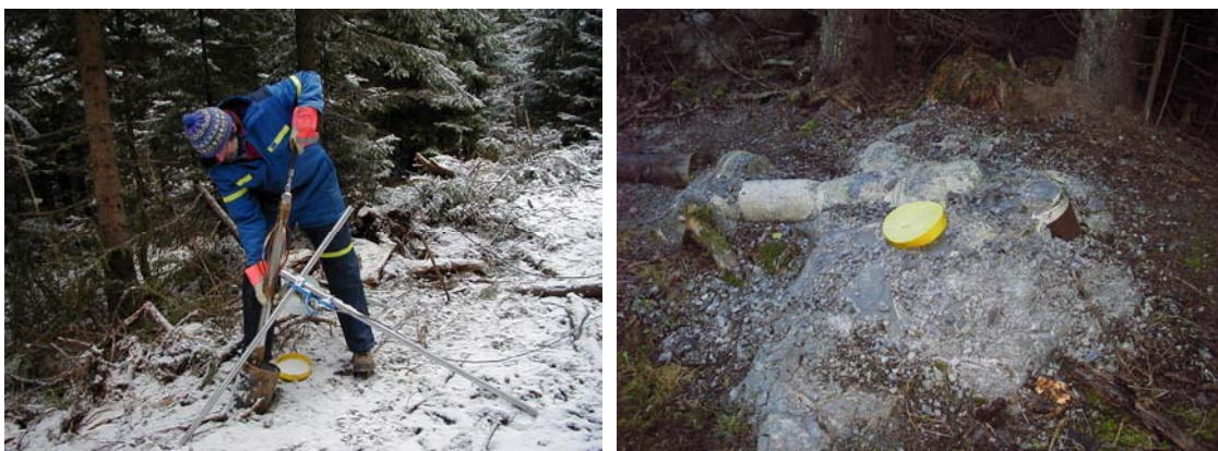
Figur 3. Optisk televiewer i Bh 6, (venstre), tetningsmasse fra tunnelen kom ut i Bh 7 (høyre).
