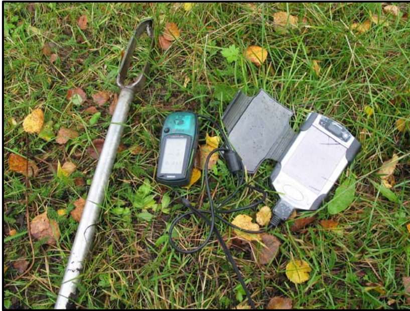
Figur 2. Typiske verktøy brukt under feltarbeidet: stikkestang, gps-måleinstrument og liten felt-pc for punktregistrering.
