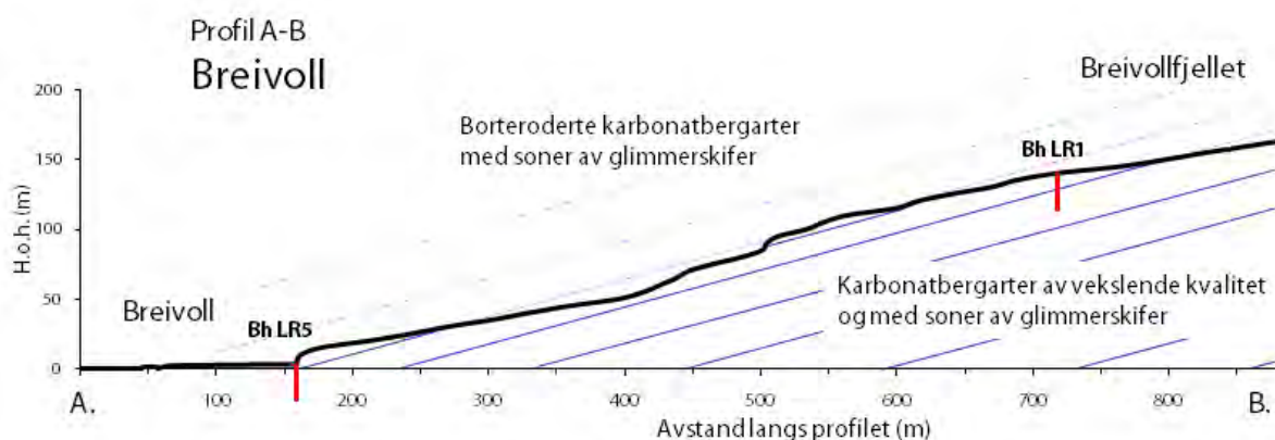
Fig. 12: Profil fra Breivoll og oppover lia mot Breivollfjellet med antydnet lagdeling. Plasseringen av profilet framgår av Fig. 11 og 13. God karbonat ligger i dette profilet i fjelloverflaten (men er i stor grad tildekket av løsmasser). Videre vestover i lia synes denne gode karbonatenheten å være overlagret av karbonat av dårlig kvalitet i veksling med soner av glimmerskifer, og er først igjen funnet like øst for Ibestadvatnet (Fig. 15).
