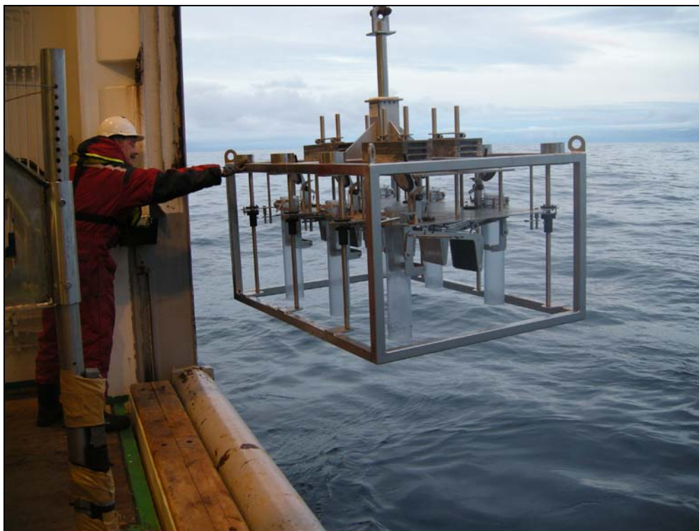
Figur 3. Multicoreren på vei ut fra skipssiden på F/F G.O. Sars, klar for prøvetaking.
