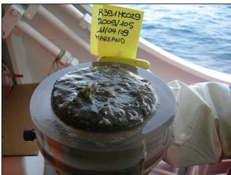
Figur 4. Multicorer toppslice (0-1 cm) fra stasjon R391 klar for å bli kuttet. Det er et stort innhold av svampespikler (ser ut som nåler) i sedimentene.
