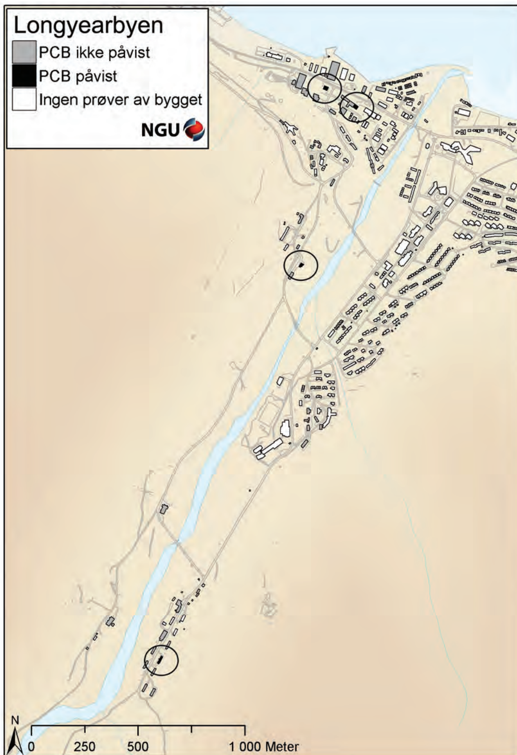
Figur 20. Kartet viser bygninger i Longyearbyen (sentrum). Svart farge betyr at det er påvist spor av PCB i maling eller betong fra ytre fasade. På dette kartet er det 4 bygninger det gjelder, og alle har lave konsentrasjoner av PCB 7 (opp til 0,8 mg/kg).
