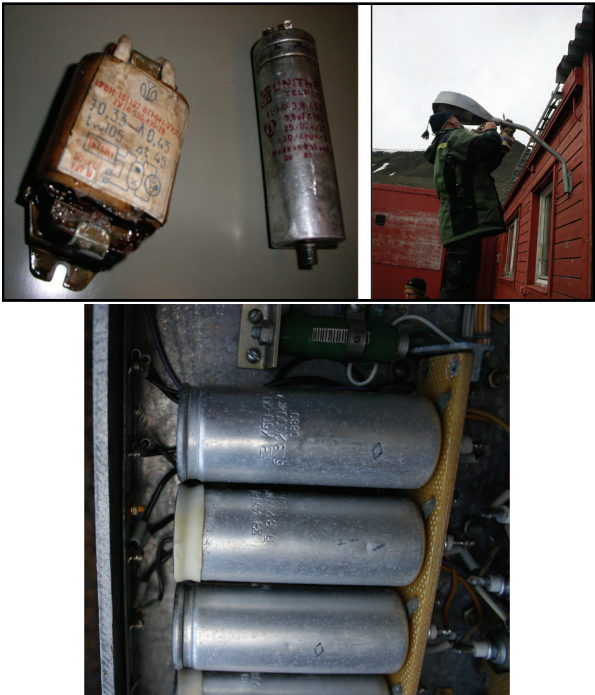
Figur 31. Eksempler på små kondensatorer fra lysarmatur og elektriske anlegg, fra Barentsburg, Pyramiden og Longyearbyen.
