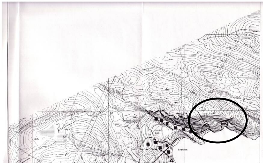
Figur 2. Kart over området ved Breivika (fra Bøe et al., 1998). Linjene angir fremtredende sprekker, stipla linje avgrensning av antatt ustabile og rasutsatte fjellpartier, firkanter angir skredavsetninger.
