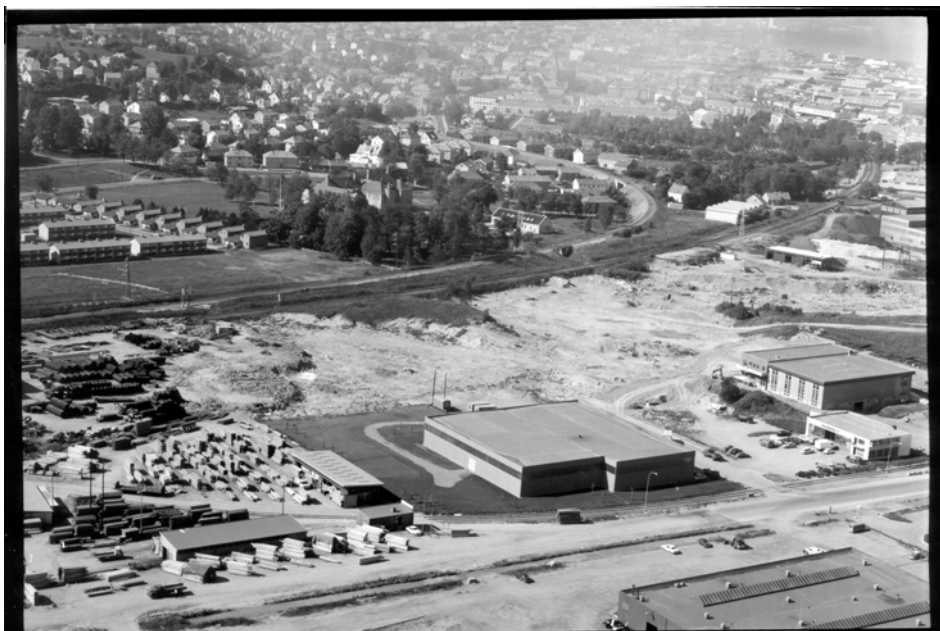
Figur 3. Ladefyllinga sett fra nord. Byggene i forgrunnen er plassert på kanten av den tidligere erosjonsdalene. Overdekningsmasser og veier inn i området ses tydelig på bildet, som er fra 1969.
