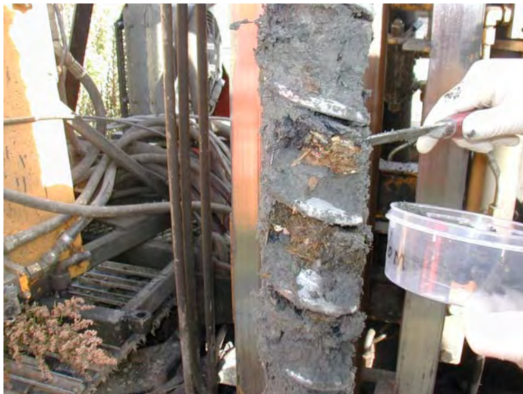
Figur 5. Borede masser med blanding av avfall og leire. Bildet er fra den miljøtekniske undersøkelsen, rapportert av Halkjelsvik m. fl. (2005).
