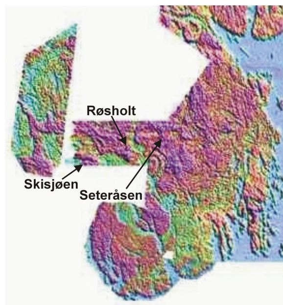
Fig. 8b. Strålingskart for thorium i samme område som i Fig. 8a. Seteråsen, Røsholt og Skisjøen Th-anomalier er angitt med piler.
