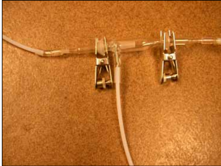
Figur 2 Bilde av blandekammer, Heliumgass med abladert prøve kommer inn fra venstre og blir blandet med argongass som kommer inn fra midten. Blandingen av helium, argon og abladert prøve går så ut til høyre til torchen i ICP-MS'en.
