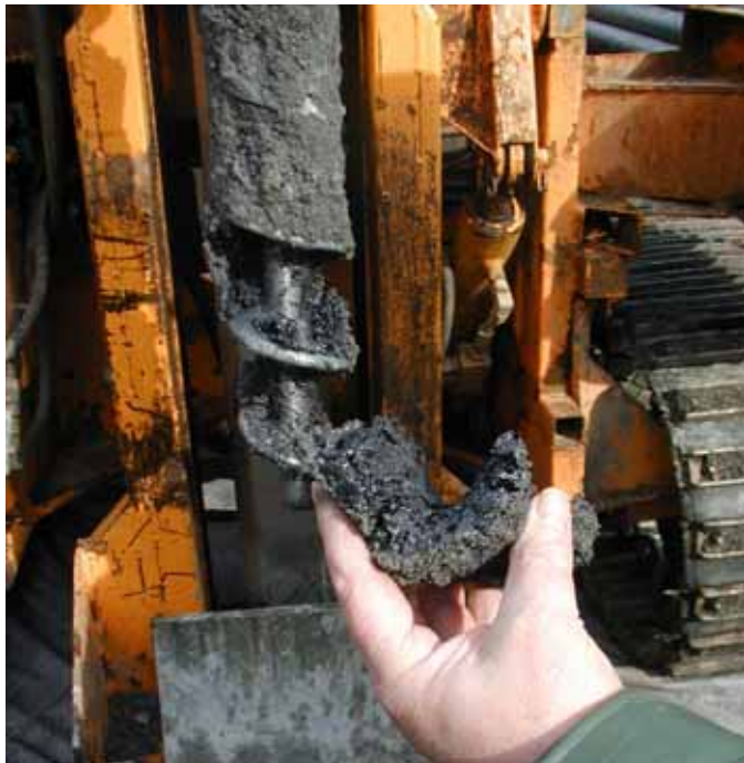
Figur 7 Oljeholdig avfall fra borehull 17 (2 – 3 meters dyp).
