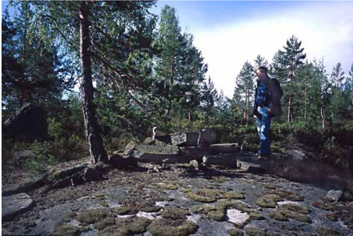
Figur 7 Lite uttak av rektangulare blokker fra naturlig benking i granitt ved Hellhei.
