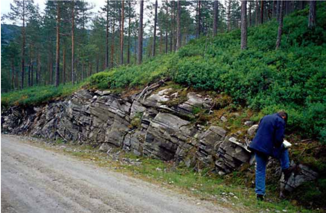
Figur 17 Veiskjæring ved Storviksanden, som viser skifrig bergart brukbar til murestein.
