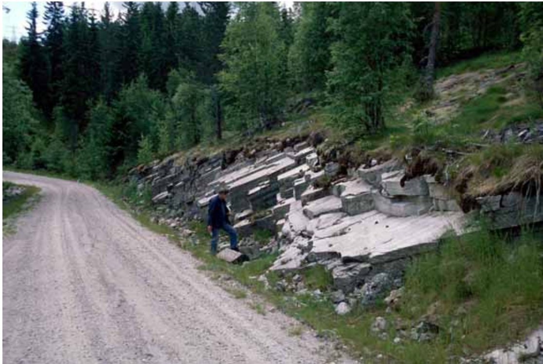
Figur 8 Veiskjæring ved Gvanntjønnstulen, kvartsittisk skifer med velegnet oppsprekking for produksjon av murestein.
