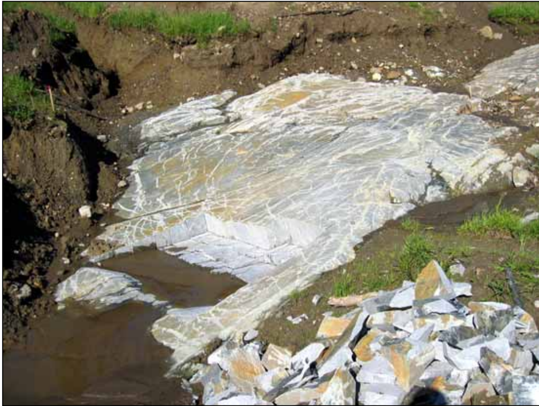
Figur 10 Oversiktsbilde av blokkuttak i område A, sett mot nordvest. Utsagede blokker (i forgrunnen) har delt seg i mindre biter rett etter uttak.
