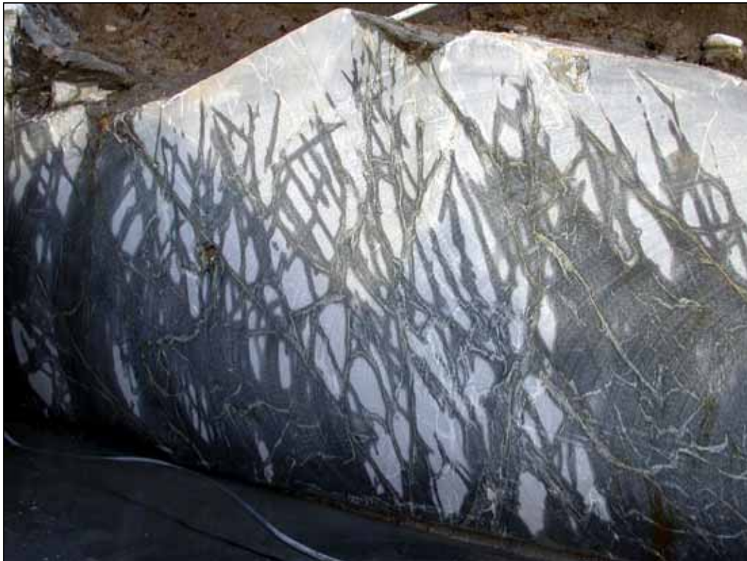
Figur 15 Åpne mikrosprekker i klebersteinen vises som mørke fuktige striper på tørr saget overflate. Fra prøveuttaket i område B, sett mot vest-nordvest.
