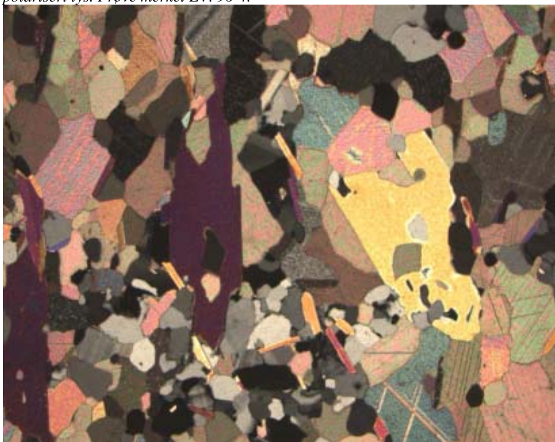
Fig. 6: Mikrostrukturer i kalkspatmarmor tilhørende Evenesflaket. Gjennomfallende polarisert lys. Prøve merket EV. 96-7.
