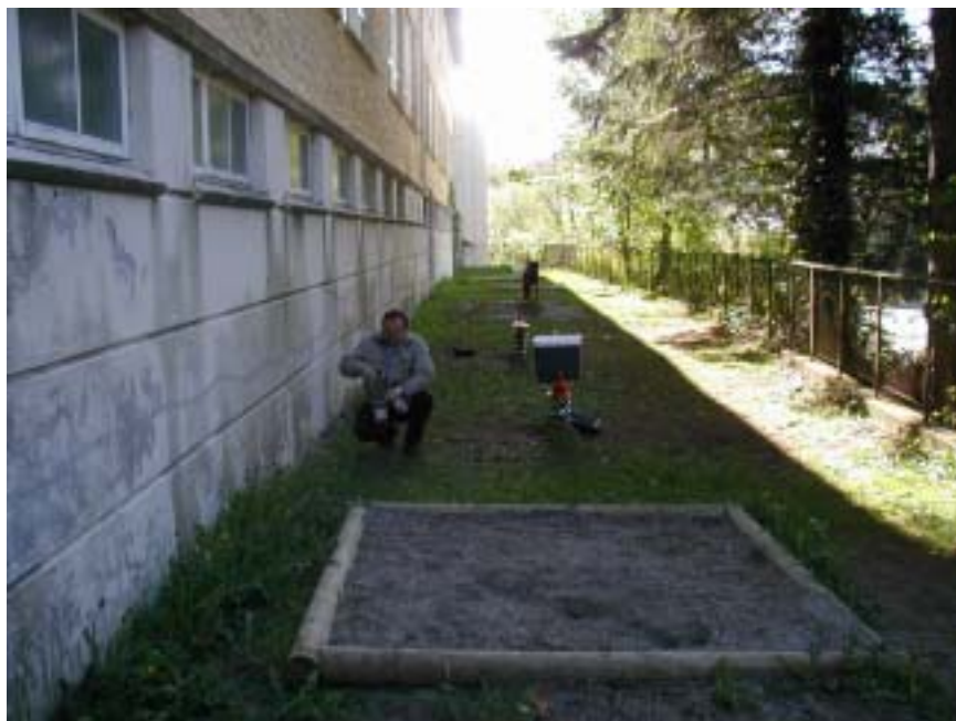
Figur 22. Prøver 25, 26 og 27 er tatt i en profil ut fra husveggen med 0,3 m, 1,3 m og 2,3 m avstand fra veggen.
