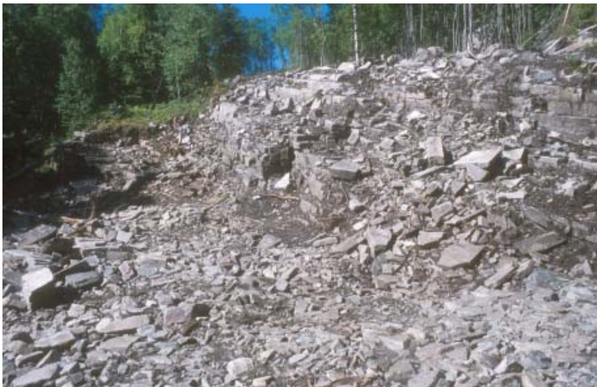
Figur 4: Sørligste del av det nordlige bruddet. Legg merke til stor grad av oppsprekking i forgrunnen (høyre side), mens i bakgrunnen er det gjennomgående skifrihet med lite oppsprekking.
