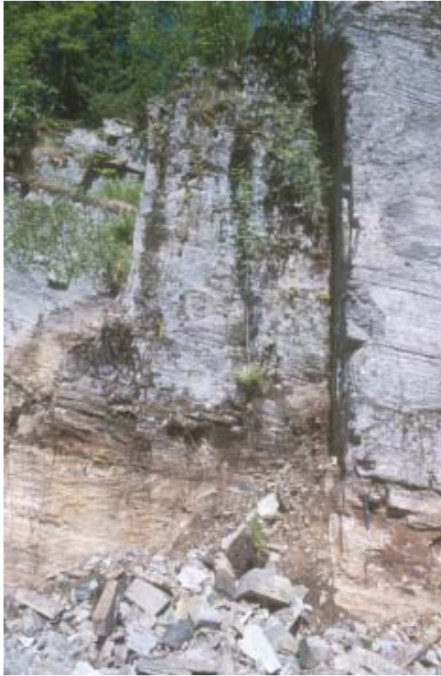
Figur 7: Lengst sørvest i det Vestre bruddet. Her er det forholdsvis stor grad av vertikal oppsprekking i øst-vest retning.
