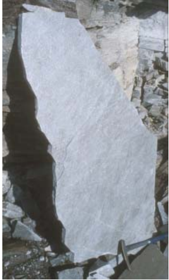
Figur 11: Spalteflate dominert av finkornet muskovitt, og med spredte svarte nåler av amfibol. Østre skiferbrudd.
