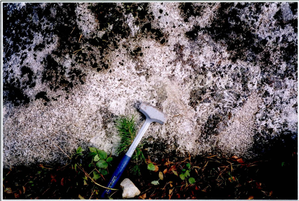
Figur 4. Noritten kan veksle fra finkornet til svært grovkornet over korte avstander. Fra parti i sørlige del av intrusivet avmerket på fig. 3. Forvitret flate.
