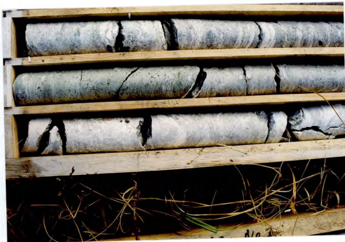
Figur 9 Borhull 100, kasse 6. Tynt klorittskiferlag i kleberstein omkring 34 m.
