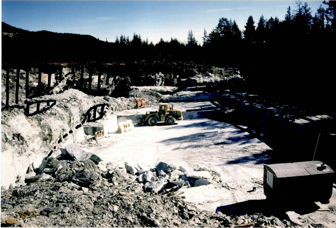
Figur 1 Oversikt over Nyseter-bruddet. Overliggende skifer samt interne skifersoner er merket med vertikale linjer, mens underliggende serpentinit er merket med prikker.
