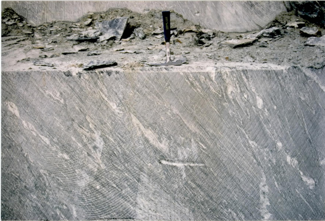
Figur 5 Foliert kleberstein med finkornete og grovkornete partier, og med foldete karbonatårer. Stedvis god kvalitet.
