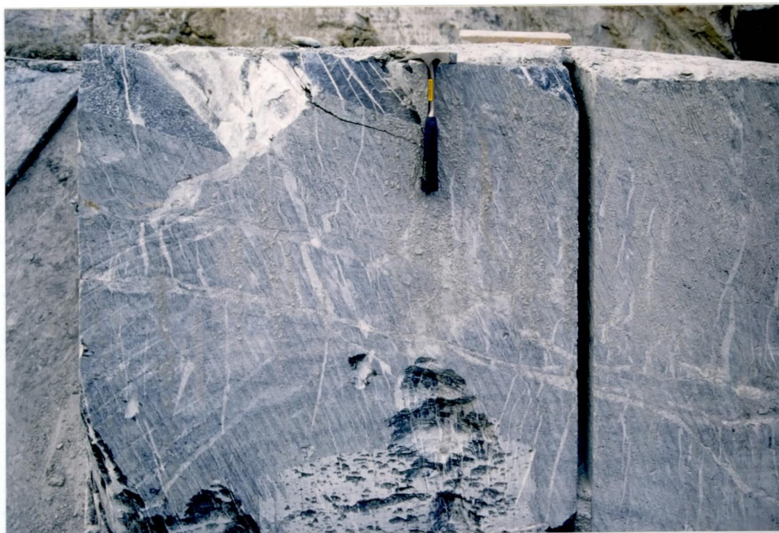
Figur 8 Talkrik serpentinit. Merk rikdommen av karbonat- og talkårer. Disse skyldes hardhetskontraster mellom kleberstein og serpentinit.
