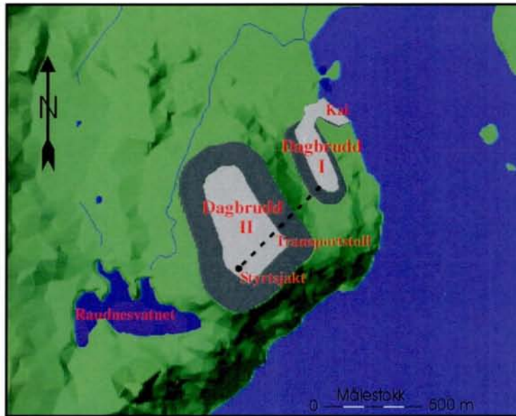
Figur 3. Utkast til plassering av anlegg.
