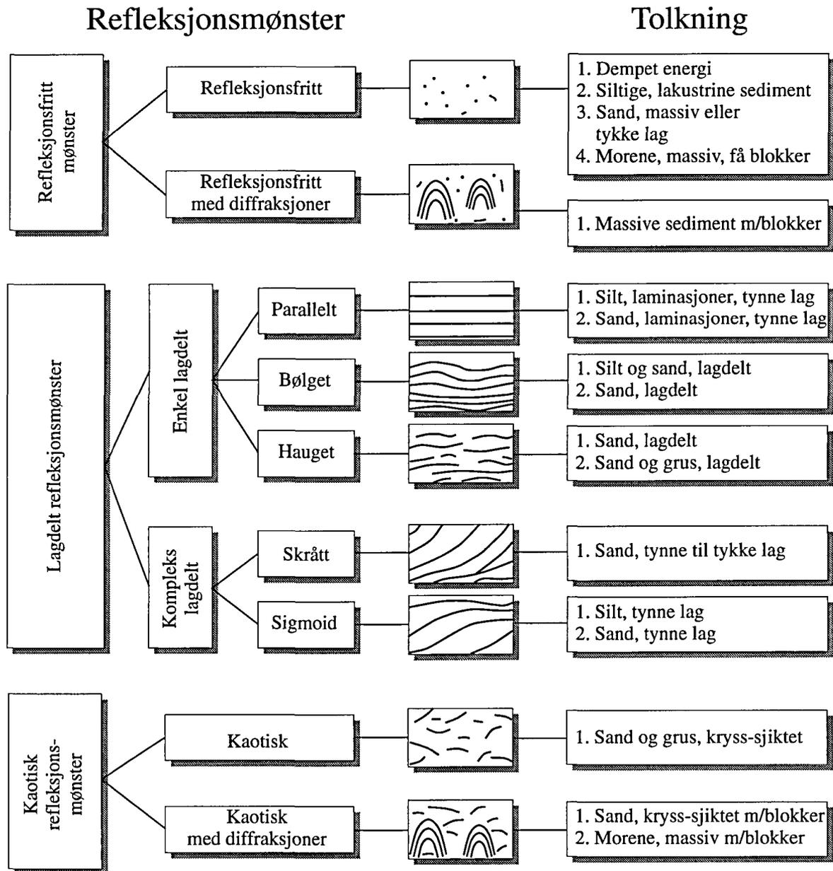
Skjema som knytter refleksjonsmønster på georadaropptak til sedimenters litologi og stratigrafi
