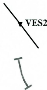
Vertikal elektrisk sondering med sonderingspunkt og retning/lengde på elektrodeutlegg
