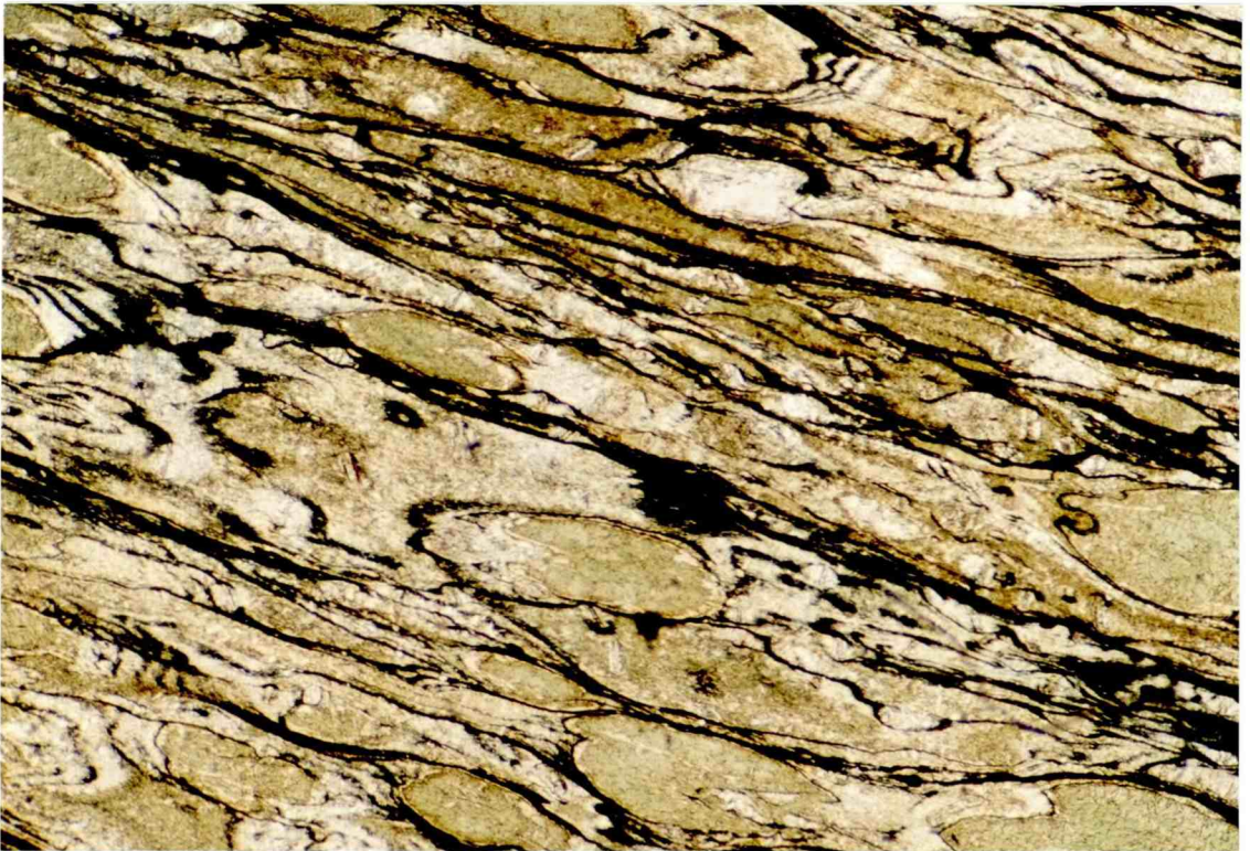
Figur 6. LN 09. Løkken. Sterkt mylonittisert og foldet bergart. På grunn av den ekstremt lave kornstørrelsen er det vanskelig å skille de enkelte mineralene, men de lysegrønne partiene består vesentlig av kloritt. Bildets bredde er ca. 4 mm.
