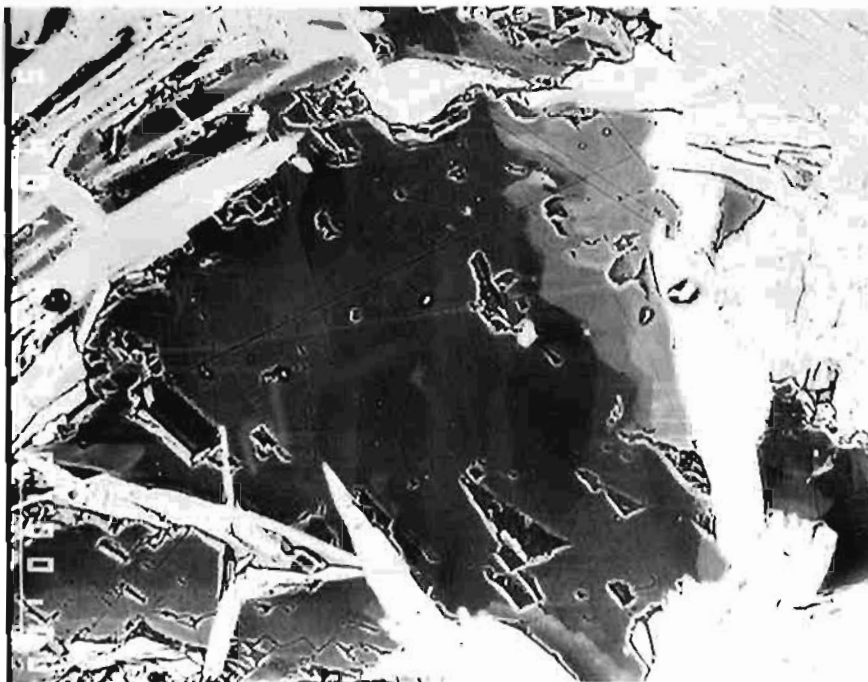
Figur 4. Sonert magnesitt med mørk Fe-fattig kjerne, en grå mellomfase og en lys grå mer Fe-rik rand. Det nesten hvite er serpentin-nåler, tildels som inneslutninger. Strek til venstre er 0.1 mm.
