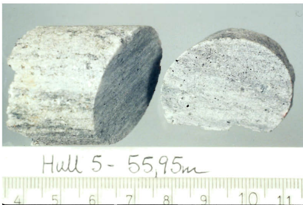
Fig. 12. Kjerneprøve hull 5 - 55,95 m. Omtrentlig mineralfordeling i tilhørende slip: ~ 30 % karbonat, 50-60 % talk, 10-15 % (?) kloritt og ~ 5 % sekundær magnetitt pluss kromitt. I slippet sees intim sammenvoksning av talk og kloritt.
