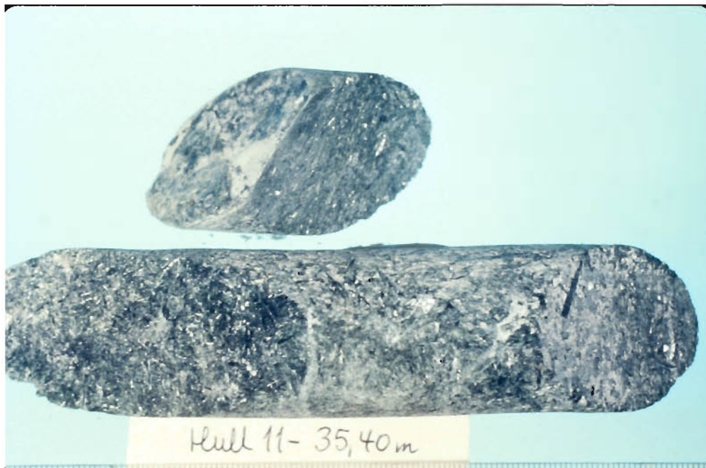
Fig. 33. Kjerneprøve hull 11 - 35,40 m. Omtrentlig mineralfordeling i tilhørende slip: ~ 50 % aktinolit, ~ 25 % talk og ~ 25 % kloritt. Aktinolitnåler med varierende størrelse ligger spredt i alle retninger i en grunnmasse av talk og kloritt. Mikrosondedata: analyse nr. 25 - 28 i bilag 3, side 6.
