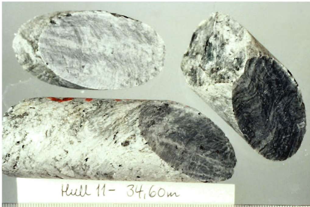
Fig. 32. Kjerneprøve hull 11 - 34,60 m. Omtrentlig mineralfordeling i tilhørende slip: ~ 70 % talk, ~ 30 % kloritt og 3-4 % sekundær magnetitt + kromitt. På tross av det relativt høye klorittinnholdet ser det ikke ut til at kloritten i nevneverdig grad har assimilert oksydene.
