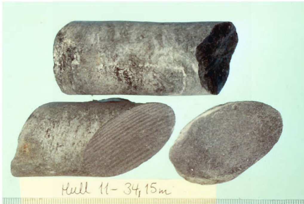
Fig. 31. Kjerneprøve hull 11 - 34,15 m. Omtrentlig mineralfordeling i tilhørende slip: ~ 50 % kloritt, ~ 40 % aktinolitt og ~ 10 % (?) talk. Aktinolitt kan sees å gå over til kloritt. Videre er det karakteristisk at det med denne mineralfordelingen ikke opptrer oksyder (kromitt og sekundær magnetitt). Dette kan skyldes det høye klorittinnholdet, - oksydene er nedbrutt og deres elementer er metasomatisk gått inn i kloritten, eller at prøven er tatt i et overgangsparti i kleberens grensesone litt utenfor det som opprinnelig var serpentinkonglomerat og som førte kromitt og sekundær magnetitt i disseminasjon.
