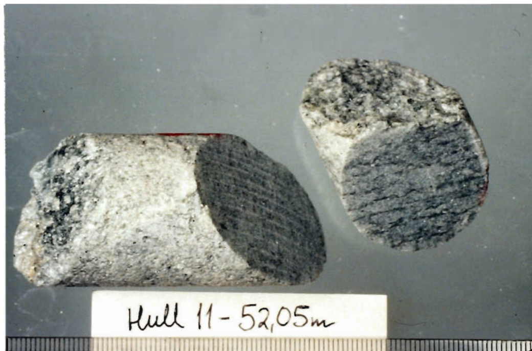
Fig. 36. Kjerneprøve hull 11 - 52,05 m. Omtrentlig mineralfordeling i tilhørende slip: ~60 % karbonat, 35-40 % talk, <5 % kloritt og 3-4 % kromitt pluss sekundær magnetitt. I slipet ble observert både grovkornet, oppsprukket karbonat med tannete korngrenser (ferro—magnesitt = breunneritt) og nydannet, fin-kornet, granulær karbonat (dolomitt). Mikrosondedata: analyse nr. 22, 23 og 24 i Bilag 3, side 5.
