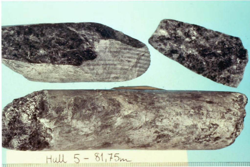
Fig. 15. Kjerneprøve hull 5 - 81,75 m. Omtrentlig mineralfordeling i tilhørende slip: ~ 40 % kloritt, ~ 40 % aktinolit, ~ 20 % talk samt aksessoriske mengder apatitt (?). Prøven er tatt fra et overgangsparti mellom kleber og klorittskifer og er derfor karakterisert ved opptreden av mye aktinolit.
