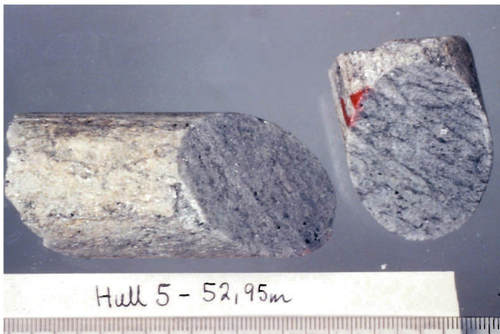
Fig. 11. Kjerneprøve hull 5 - 52,95 m. Omtrentlig mineralfordeling i tilhørende slip: ~ 60 % karbonat, ~ 30 % talk, <5 % (?) kloritt og ~ 5 % sekundær magnetitt + kromitt.
