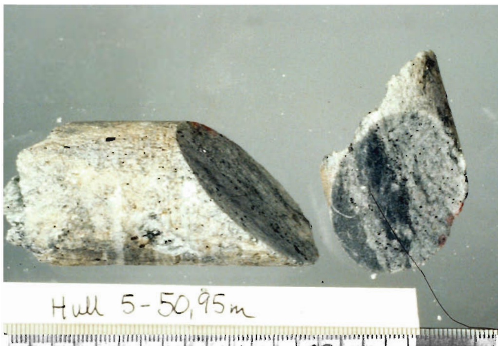
Fig. 10. Kjerneprøve hull 5 - 50,95 m. Omtrentlig mineralfordeling i tilhørende slip: 40-50 % karbonat, 40-50 % talk, \sim 5 % (?) kloritt og \sim 5 % sekundær magnetitt + kromitt. Karbonatene opptrer på samme måte som i fig. 5 - 9. Videre er observert talk pluss finkornet dolomitt og grovkornet breunneritt i aggregatform (mer sammenvokst enn vanlig?).
