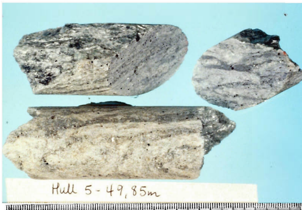
Fig. 9. Kjerneprøve hull 5 - 49,85 m. Omtrentlig mineralfordeling i tilhørende slip: \sim 70 % karbonat, 25-30 % talk og \sim 5 % sekundær magnetitt pluss kromitt. Karbonatopptreden på samme måte som i fig. 5 - 8.
