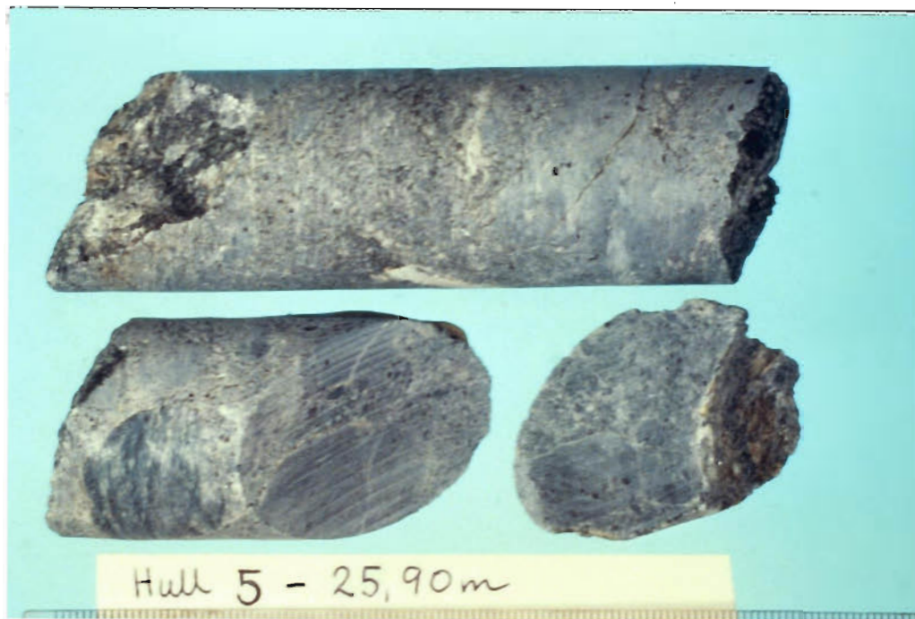
Fig. 3. Kjerneprøve hull 5 - 25,9 m. Omtrentlig mineralfordeling i tilhørende slip: \sim 20\% karbonat, 5-10 % (?) kloritt, et meget finkornet aggregat av \sim 50\% talk og \sim 25\% serpentinrester og tilslutt \sim 5\% kromitt og sekundær magnetitt. I slipet kan sees serpentin under omvandling til talk både i boller og matriks. Enkelte små serpentin"boller" (egentlig sandkorn og gruskorn av serpentin) er helt uangrepet av talkifiseringsprosessen.
