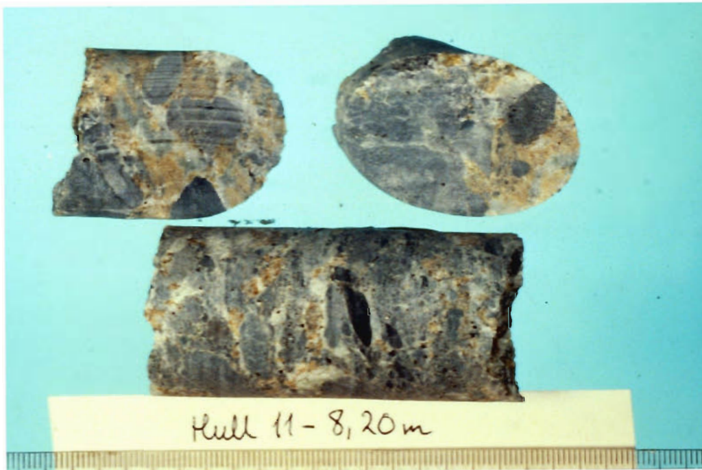
Fig. 20. Kjerneprøve hull 11 - 8,20 m. Omtrentlig mineralfordeling i tilhørende slip: ~50 % karbonat, ~25 % talk, ~20 % (?) serpentinerester, ~5 % (?) kloritt og 2-4 % sekundær magnetitt pluss kromitt. I slipet sees serpentin under omvandling til talk.
