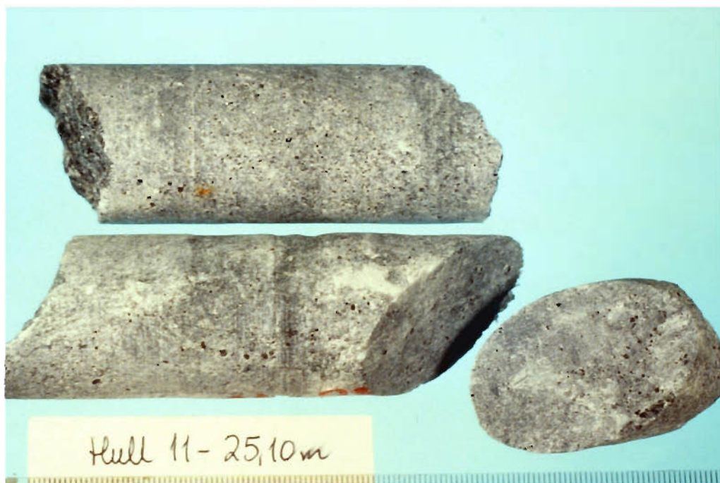
Fig. 27. Kjerneprøve hull 11 - 25,10 m. Omtrentlig mineralfordeling i tilhørende slip: 70-80 % talk, ~ 10 % karbonat, 5-10 % (?) kloritt og ~ 5 % sekundær magnetitt + kromitt. Jfr. mikrosondeanalyse nr. 1 - 7 i Bilag 3, side 1 og 2.
