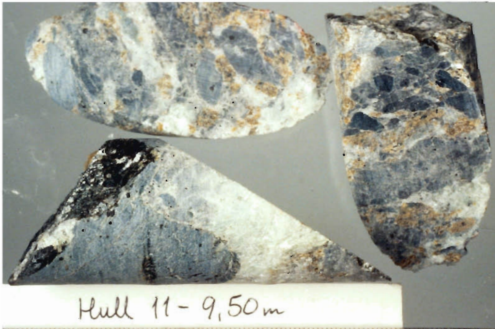
Fig. 22. Kjerneprøve hull 11 - 9,50 m. Omtrentlig mineralfordeling i tilhørende slip: 40-50 % karbonat, et finkornet aggregat av ~ 40 % talk og ~ 10 % (?) serpentinrester. Videre <5 % kloritt og 3-4 % sekundær magnetitt pluss kromitt. Prøven viser noe sterkere omvandling enn prøve 11 - 8,20 m.
