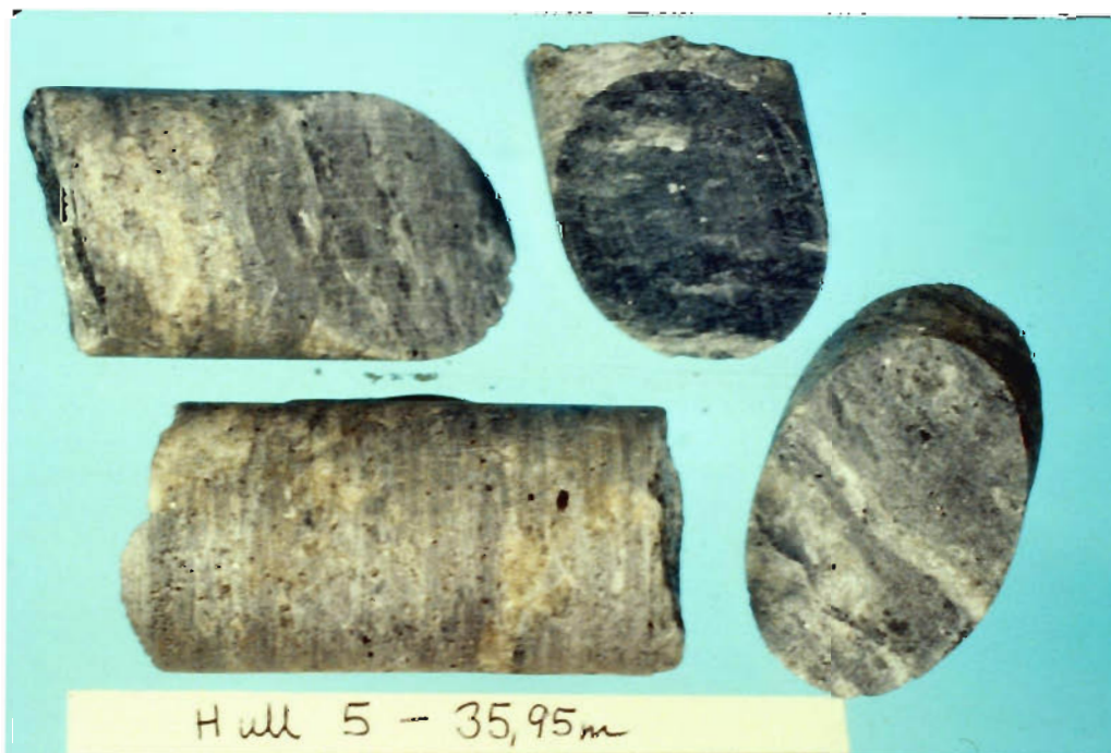
Fig. 4. Kjerneprøve hull 5 - 35,95 m. Omtrentlig mineralfordeling i tilhørende slip: \sim 20\% serpentinrester, 50-60 % talk, <10\% kloritt, \sim 20\% karbonat og 3-4 % kromitt pluss sekundær magnetitt. I slipet sees serpentin under omvandling til talk og kromittkorn med en lys brun (kromrik) kjerne og mørk (jernrik) randsone.
