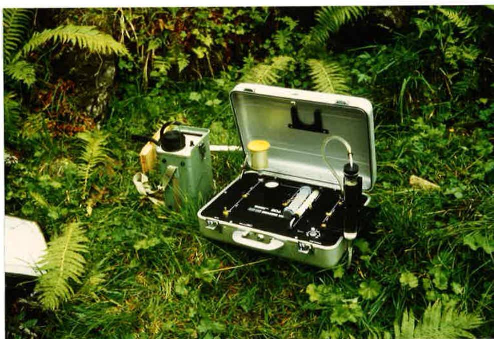
Fig. 1: Bildet viser hele måleapparaturen oppstilt, ferdig til bruk. Vannmåleeeenhten, som ble brukt for første gang på dette oppdraget, består av metallkofferten på bildet samt ei pumpe for å lage undertrykk. Elektronikkeenhten er den grønne boksen til venstre for kofferten. Metallsylindere med gul topp til venstre i kofferten har et ZnS-belegg med den egenskap at det "kondenserer" \alpha -strålingen fra radongassen. Disse sylindrene er av lignende type som for måling av jordluft, men med den forskjell at disse har en lukkemekanisme slik at de automatisk stenges når de tas av panelet på kofferten.
