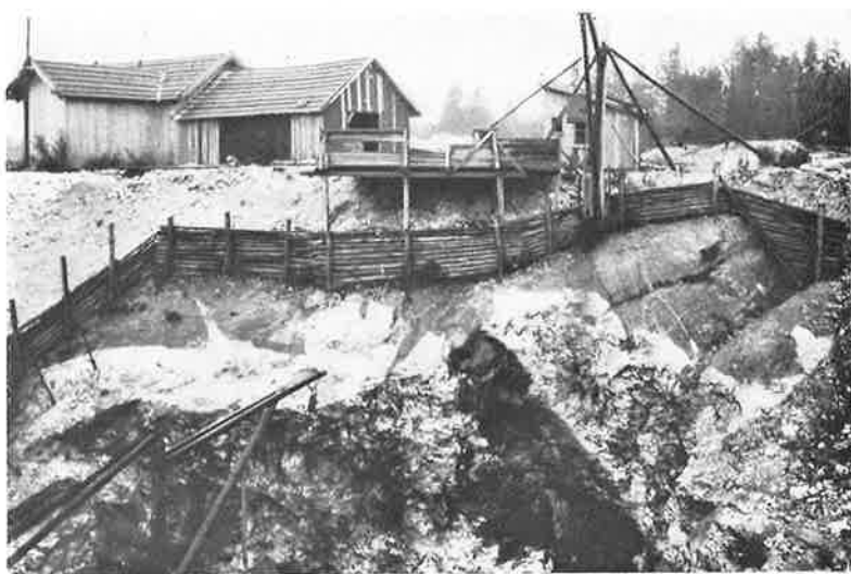
Fig. 64. Feltspatbrudd ved Stryker i Rakkestad. Pegmatiten ligger under gneis; dens uregelmessige øvre grense sees skarpt tvers over bildet (under gjerdet). Bruddet har form av en dyp og vid synk. Endel av heiseinnretningene sees på bildet.
