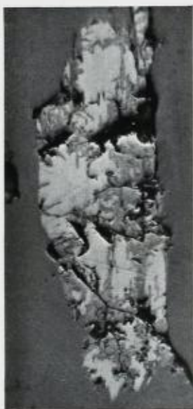
Fig. 2. Pentlanditt i magnetkis. Viderekommen bravoittdannelse. Oljeimmersjon. \times 600 .
