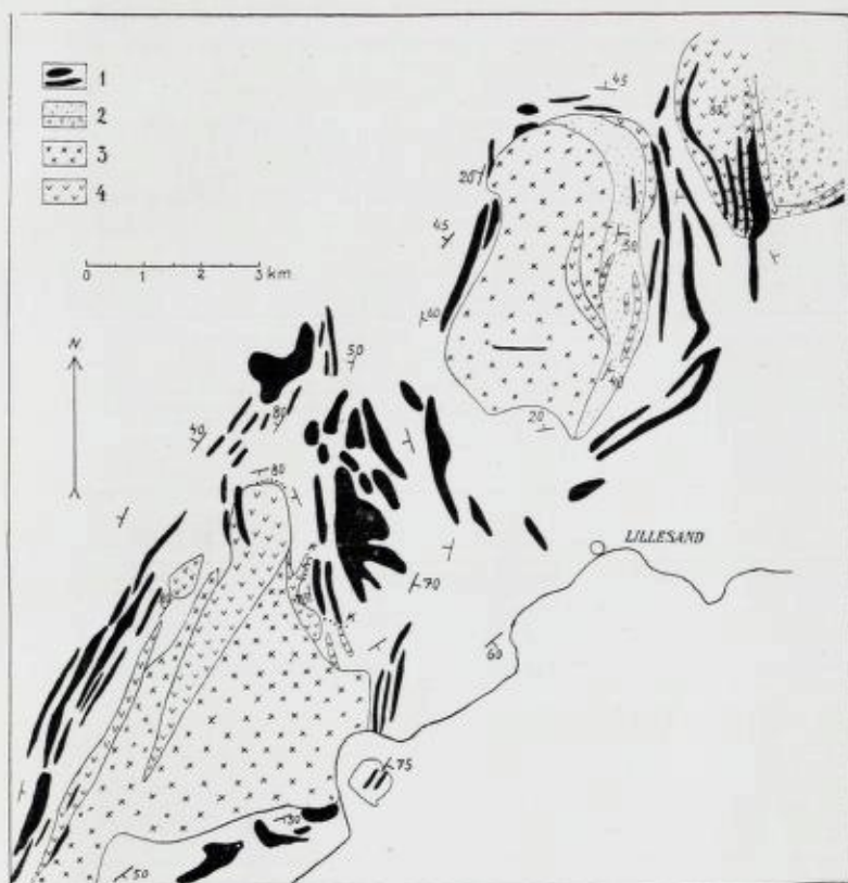
Fig. 29. Utsnitt av geologisk kart over Bambleformasjonen i den vestlige del av Sørlandet. 1. pegmatittganger, 2. kvartsitt og kvartsitt med konglomeratlignende inneslutninger, 3. granitt, 4. gabbro (amfibolittiseret).
