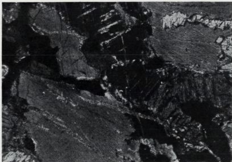
Fig. 20. Syenitt. Rauberg n. f. Storeskar. Viser mikropertitt, pyroksen og magnetitt + nic. 60 × forst.
