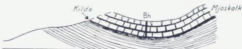
Fig. 5. Artesisk brønn (Bh.) i Mjøsalkalk på Nes. Mellom kalken og skiferen under er det et vanntett skiferlag. Artesian well (Bh.) in the Mjøsa limestone.
