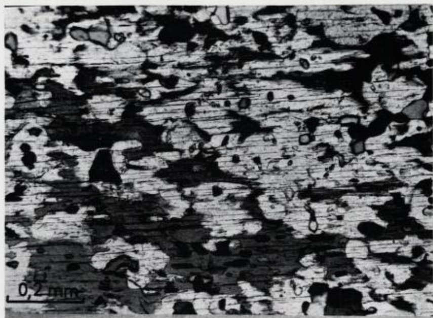
Foto nr. 5. Diopsid (lyst) som flekkevis er omdannet til hornblende (mørkt). Inneslutninger av kvartskorn. X nicoller. Fra en delvis amfibolittisert og skapolittisert gabbro ca. 200 m SØ for Bingsås.
