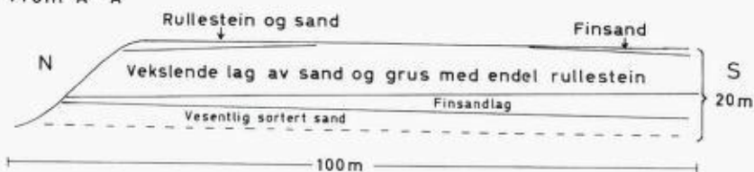
Fig. 29. Snitt i jernbanens grustak ved Hauerseier. Section through the Hauerseier gravel deposit.
